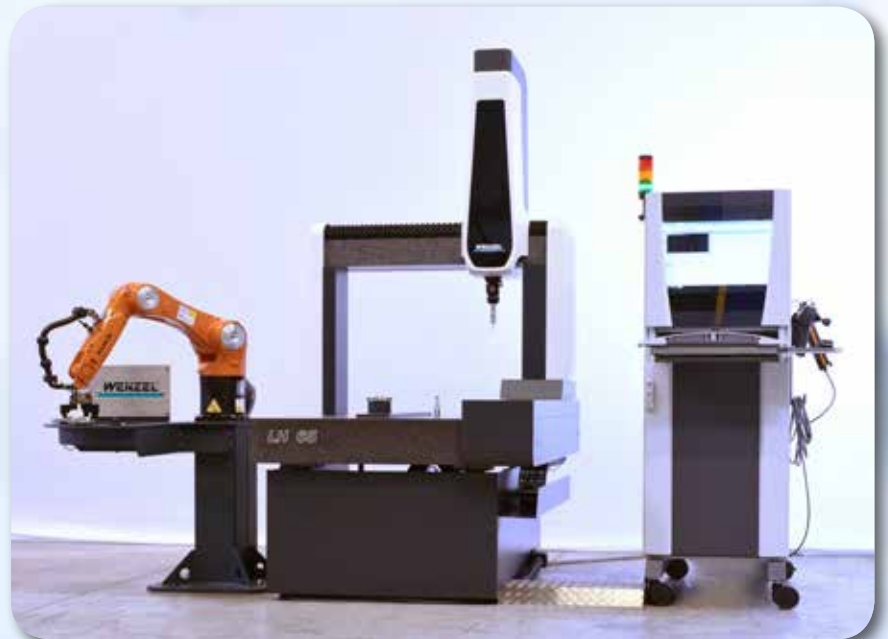
Linienintegriertes Koordinatenmessgerät mit automatischer Bestückung über einen Industrieroboter.
