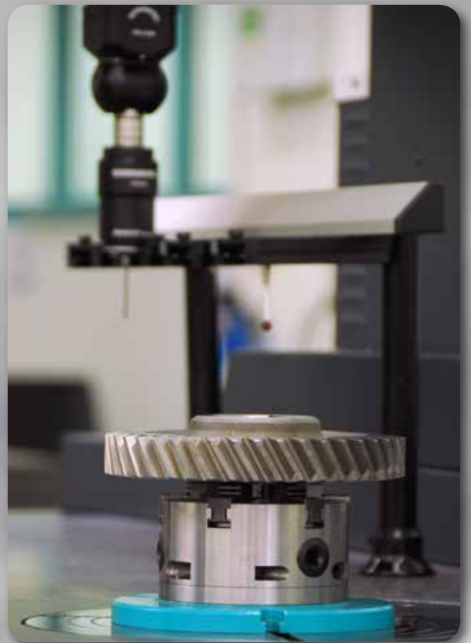
Der hochpräzise Drehtisch ermöglicht die flexible und genaue Messung von Verzahnungen und rotationssymmetrischen Bauteilen.
